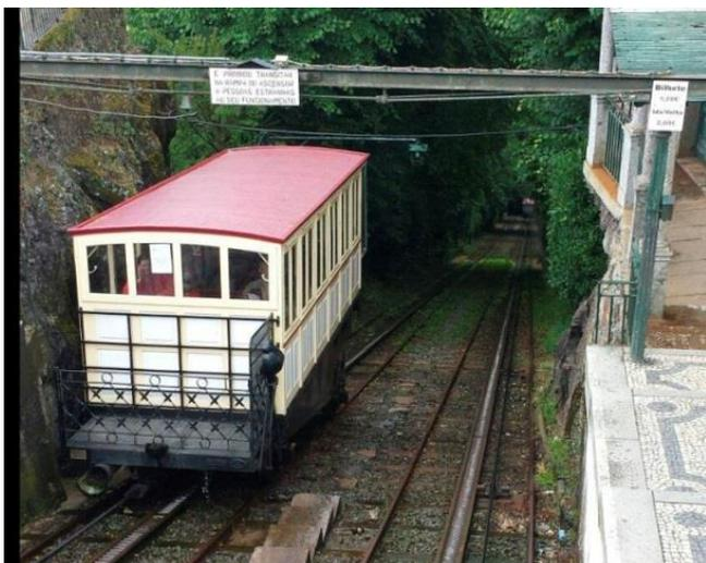
Zurück geht es mit dem Funi. Es ist noch im Originalzustand (Baujahr 1882) und wird mit Wasserfüllung der oberen Kabine betrieben, um die untere hochzuziehen. Das gleiche System war im Funicolare vom Bahnhof Lugano in die Stadt hinunter, bis in die 60er Jahre, in Betrieb.
