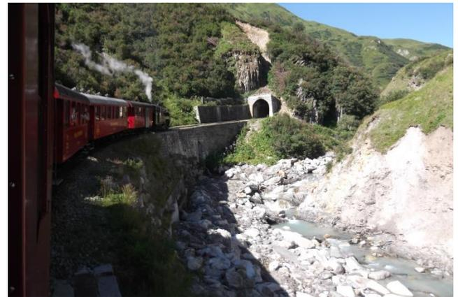
Am 10. August 2010 war dann die gesamte Strecke von 17.8 km fertig. 13.5 km von dieser Strecke fährt die Bahn mit Zahnstangen bei einer maximalen Steigung von 118 ‰. Dabei durchfährt sie viele Tunnel und überquert zahlreiche Brücken, verbraucht für Hin- und Rückfahrt 1'500 kg Kohle und 10'000 Liter Wasser. Über 700 Personen arbeiten bei der Bahn.
